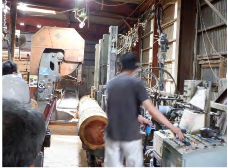
帯鋸盤で良材と並材を製材する様子
