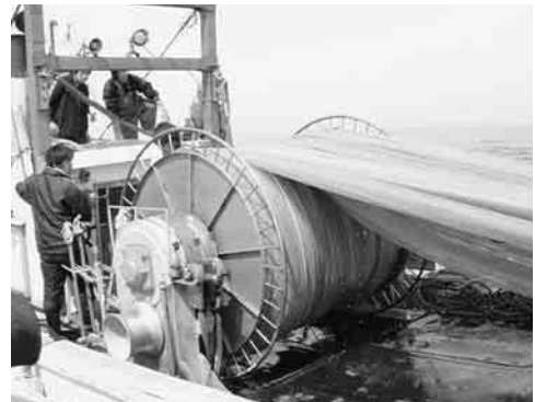
写真2 大きな巻き揚げ機で網を巻きます
