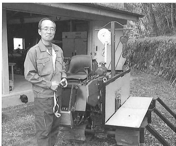
今回取材に応じてくださった川井さん （後方は、自作の林内作業車2号機。『遊びみたいなもの』とご本人は謙遜されるものの、重量1.8tの集材機能を備え、ウィンチの巻取りはリモコン操作で行う優れたもの。車両のベースはコンバイン。）
